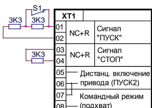
15. Если используемая на объекте система пожарной сигнализации имеет в своём составе адресные релейные модули, то сигнал "ПУСК" также может подаваться замыканием «сухих» контактов релейного модуля. Релейный модуль должен устанавливаться внутри шкафа управления при монтаже шкафа на объекте.
