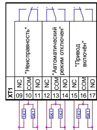
В этом случае реализуется возможность проверки контрольного шлейфа на исправность со стороны прибора пожарного управления (ППУ).
